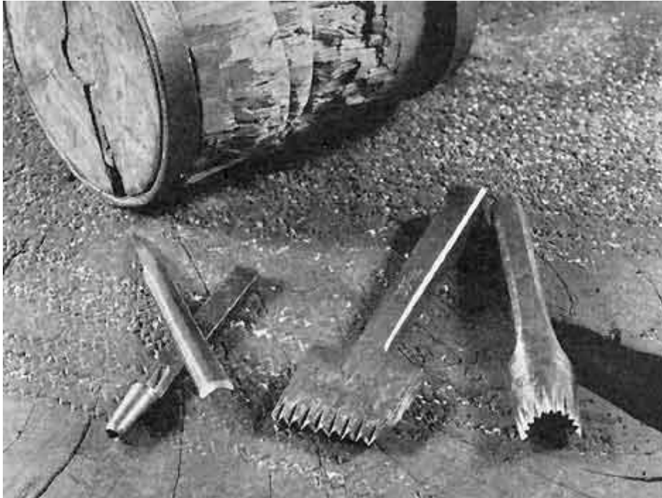
Fig. 4. Et udvalg af huggejern til fremstilling af huller, tunger og takker, mus.nr. 10.839-10.843/1962. Lennart Larsen fot.
